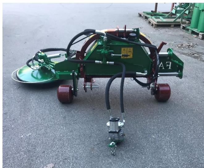
**IT** Disco interfilare idraulico indipendente applicabile direttamente al trattore tramite l'attacco a 3 punti. È alimentato dalla presa di forza e collegato alle prese idrauliche del trattore. È dotato di: serbatoio, pompa, distributore, innesti idraulici, moltiplicatore di giri, kit spostamento laterale. Kit tastatore idraulico a richiesta.
